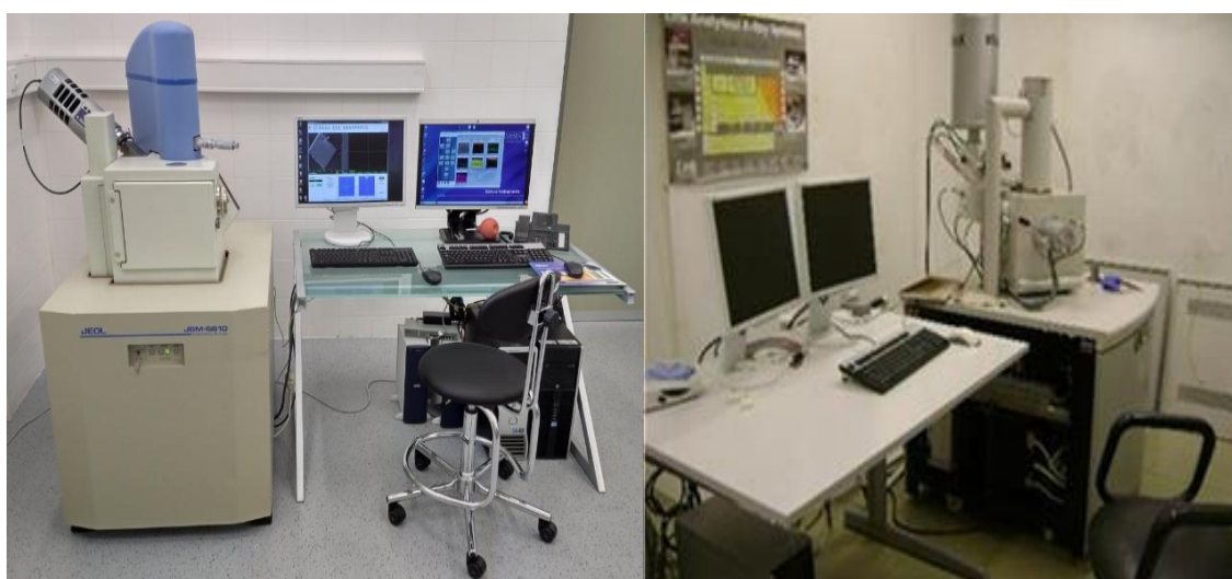
Сурет 4 – Зерттеуде қолданылған Quanta Inspect (FEID8334) және JSM-6610LV сканерлі электронды микроскопы
